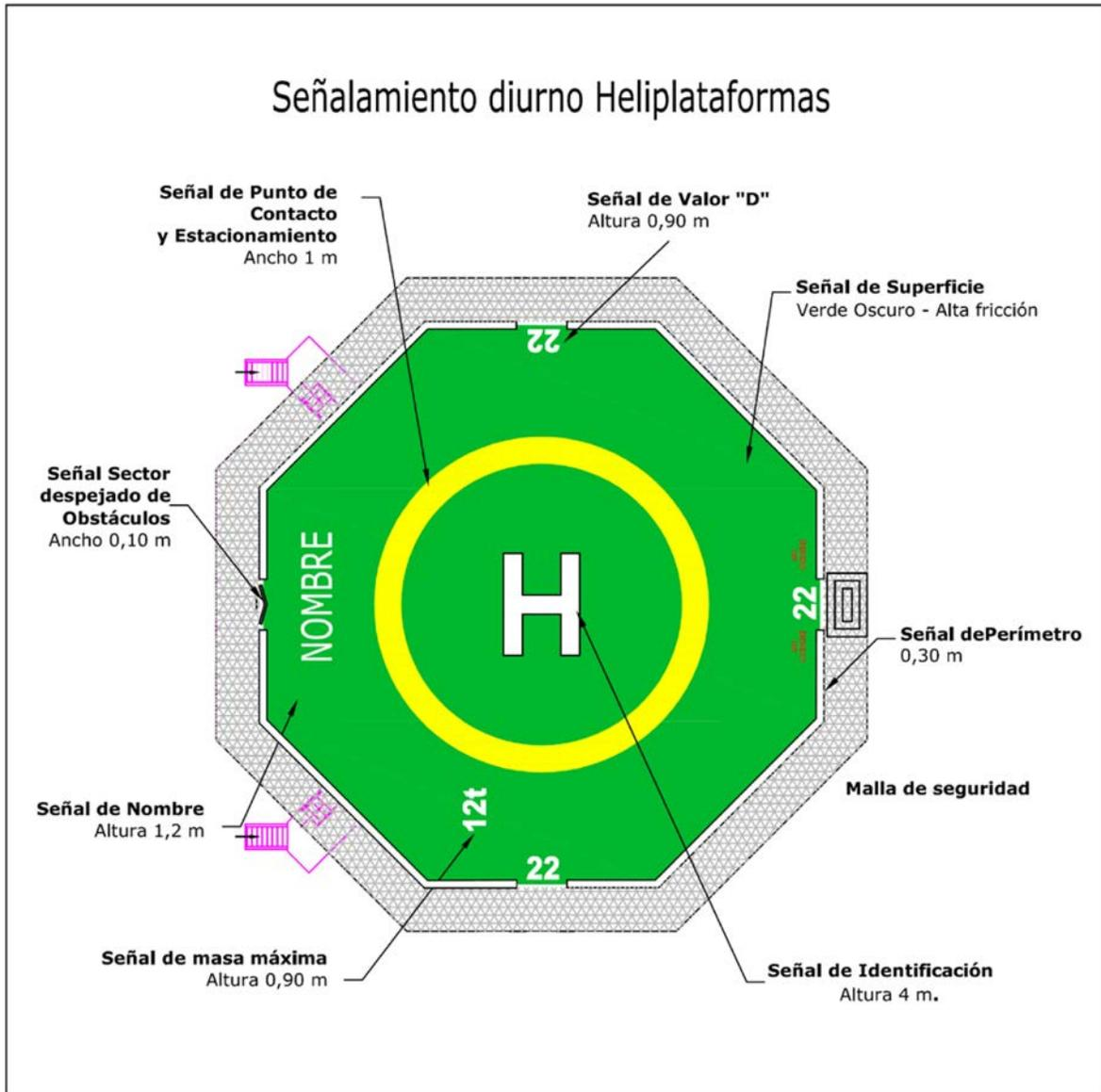
**Figura A-5-8. Señalamiento de heliplataforma**
